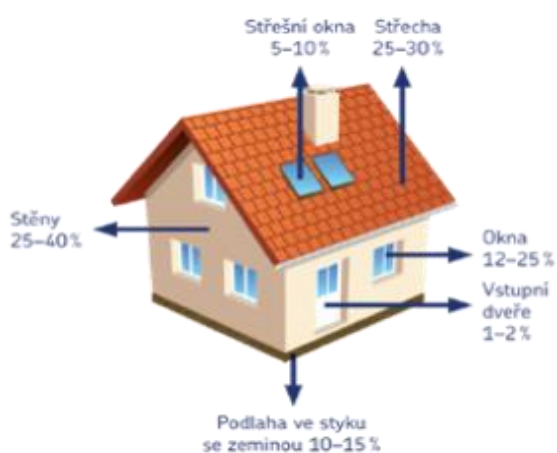
Obr. 39 Tepelné ztráty RD (zdroj: URSA CZ)
